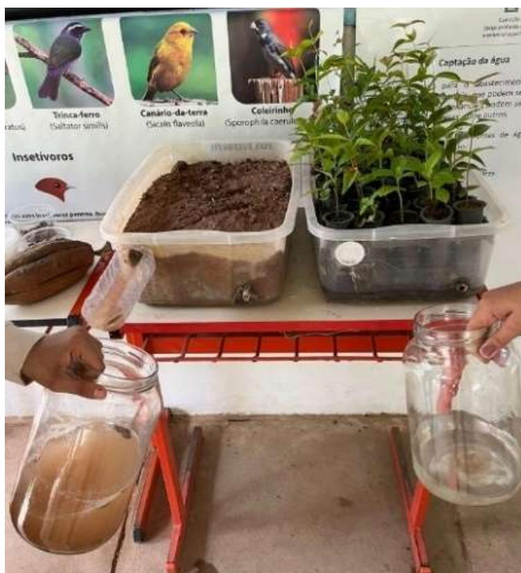
Figura 5 – Ensaio simulando o efeito de chuva em solo degradado e não degradado para observação da infiltração da água. Fonte: Produção do autor (2023).
